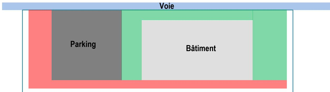
Le stationnement des vélos cargo ou assimilés est plutôt à appréhender à la manière du stationnement automobile compte tenu des contraintes propres à ce type de vélos (rayon de braquage, encombrement, poids, etc...). Il est ainsi préférable de réaliser ces emplacements vélos dans l'espace dédié au stationnement automobile du projet tout en leur réservant un espace bien identifié et conforme aux dispositions du règlement du PLUi.
